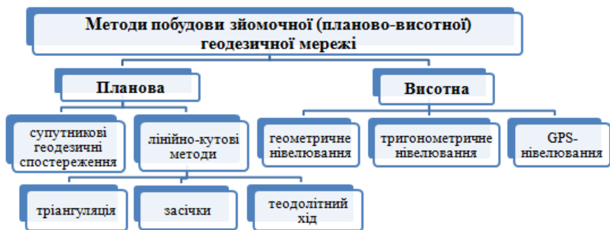
Рисунок 4.4 – Методи створення зйомочної (планово-висотної) геодезичної мережі
