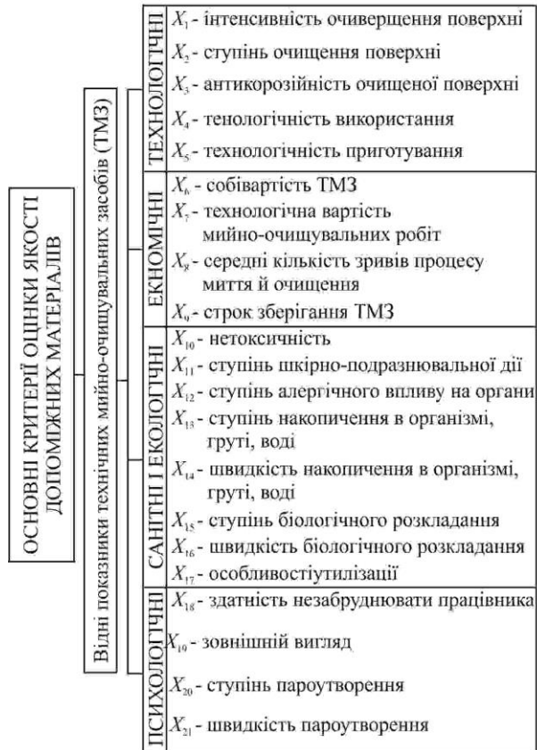
Рис. 1. Критерії оцінки якості допоміжних матеріалів, що використовуються під час виробництва й ремонту виробів транспортних трубопровідних систем
