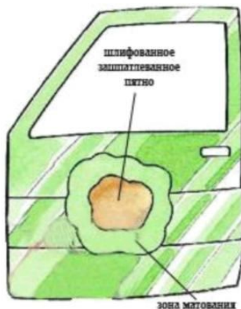
Рисунок 6 – Нанесення шпатлівки на поверхню металу
