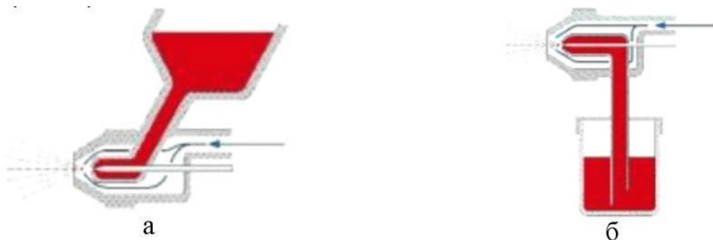
Рисунок 2 – Принцип дії краскопультотом: бачок розташований над краскопультотом (а) і під ним (б)
