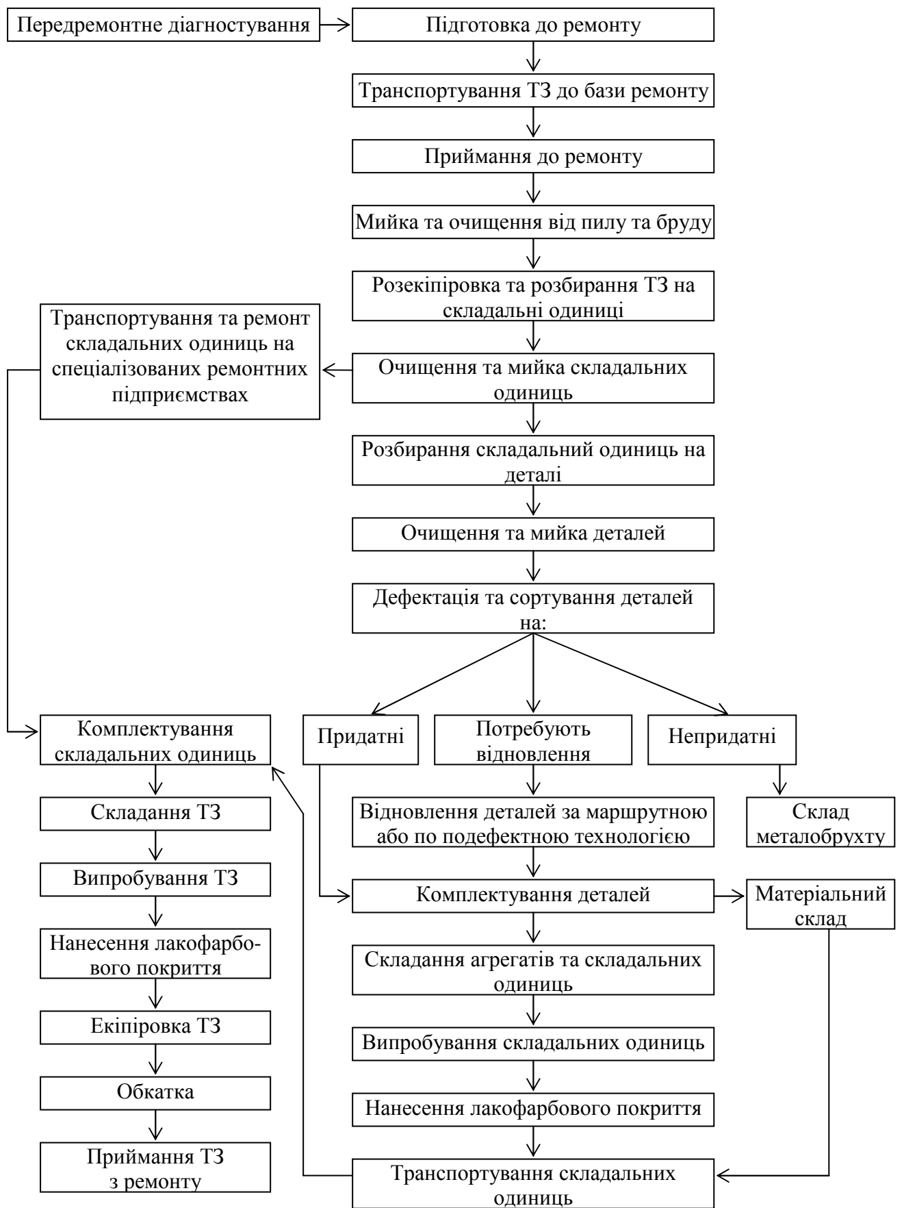
Рисунок 3.1 – Блок-схема виробничого процесу ремонту транспортних засобів
