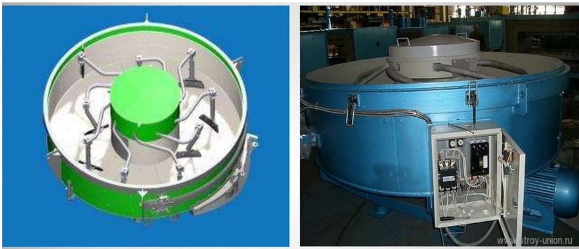
Рисунок 2.4 – Загальний вигляд таріль частого змішувача шихти
