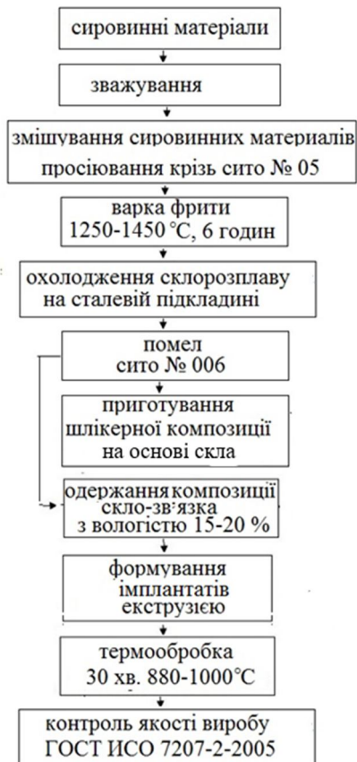
Рисунок 7 – Технологічна схема одержання біоактивного склокристалічного матеріалу
