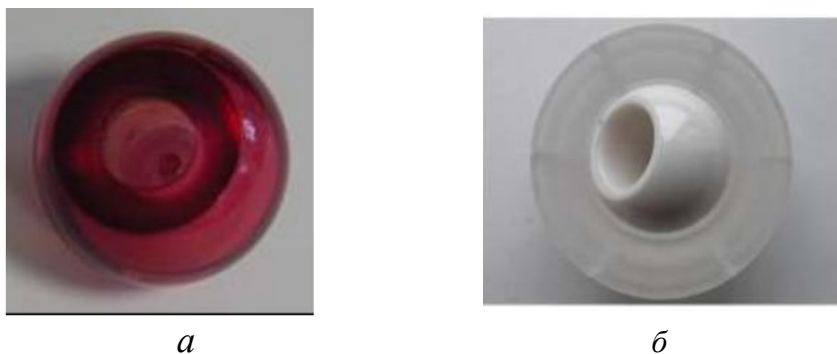
Рисунок 3.2 – Головки протезу стегневого суглоба на основі сапфіру (а) Пара тертя вкладка кульшової чаші із сапфіру, стегнова головка із ZrO_2 (б)
