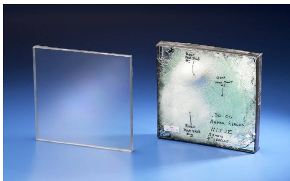
Рисунок 3.1 – Прозора бронекераміка на основі сапфіра
