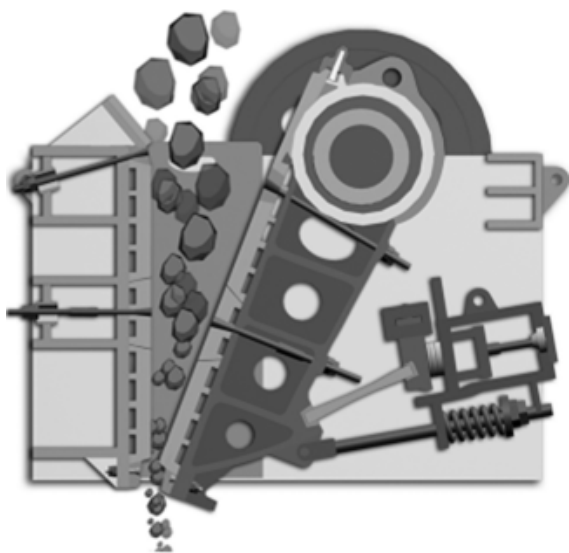
Рисунок 3.5 – Щокова дробарка (машина для грубого попереднього подрібнення матеріалів)
