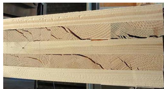
Рис. 4. Схема руйнування дощок поперечних шарів при роликовому зсуві
