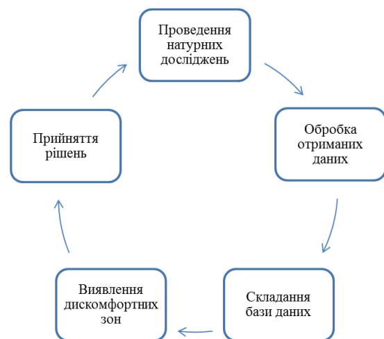
Рис. 1. Схема щорічного циклу моніторингу рівнів автотранспортного шуму
