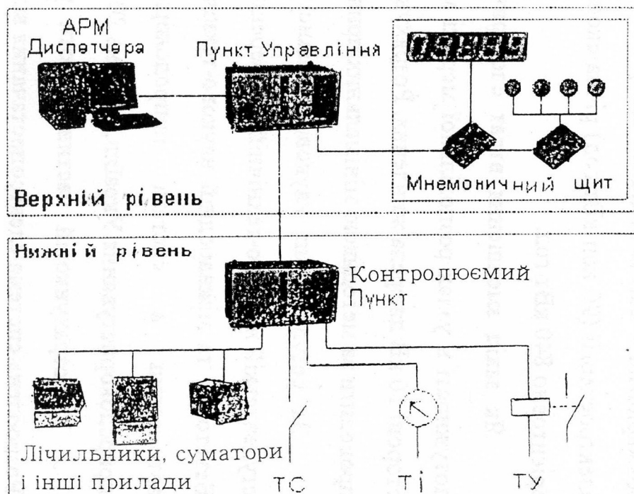
Рисунок 1.1 – Дворівнева система телемеханіки
