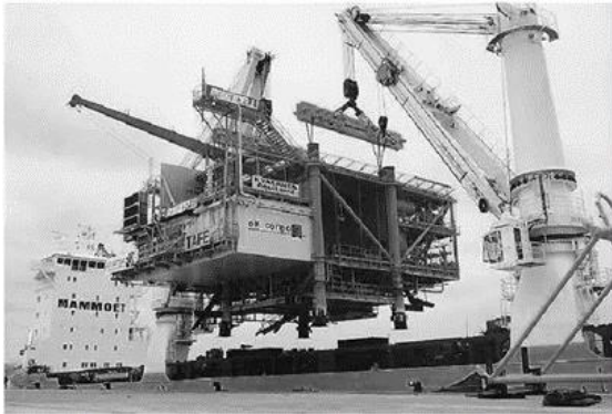
Рис.1 Вивантаження палубного вантажу судном компанії Mammoet.
