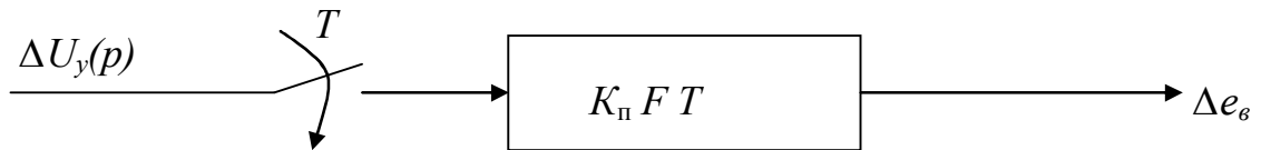
Рисунок 5.54 – Імпульсна модель тиристорного випрямляча і перетворювача з ШІМ
