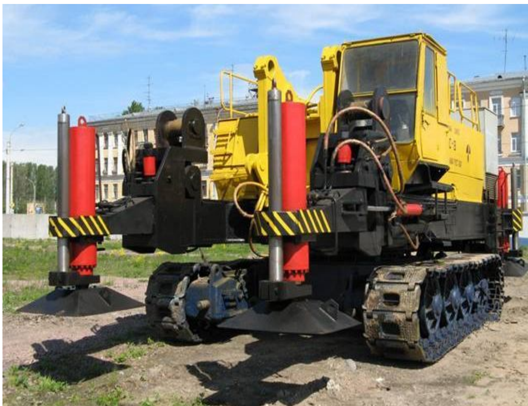
Рисунок 2.30 – Установа вдавлювання палей УСВ 160 на гусеничному візку екскаватора ЕО – 6122
