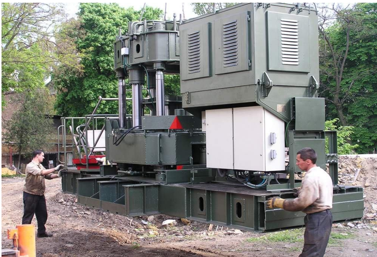
Рисунок 2.31 – Установка вдавлювання палі СО 450
