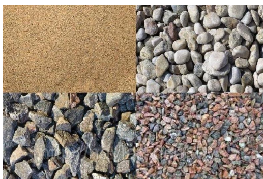
Рисунок 3.3 – Різновиди заповнювачів для бетонів: пісок, гравій, щебінь та гранвідсів
