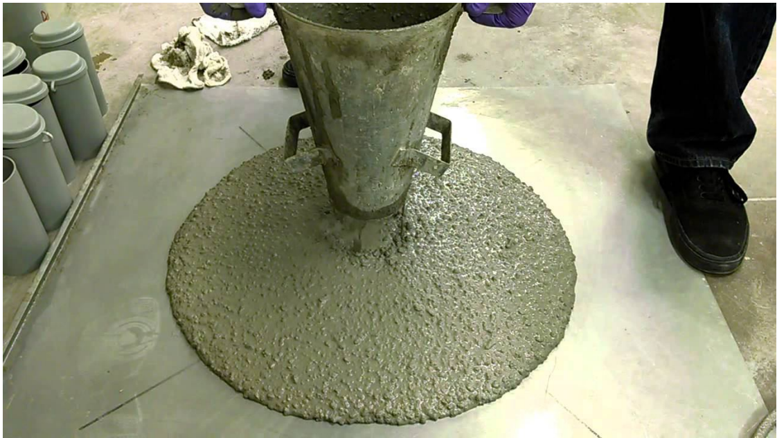
Рисунок 3.14 – Перевірка рухливості самоущільнювального бетону
