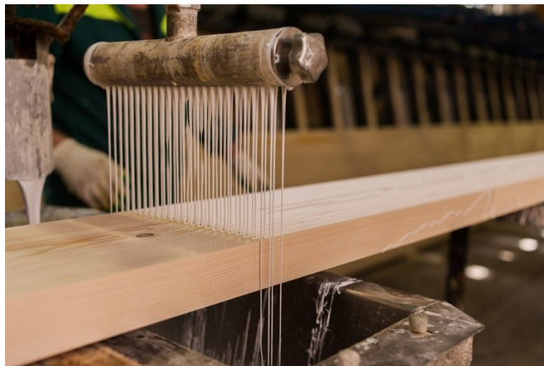
Рисунок 6.3 – Процес проклеювання ламелей
