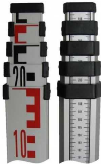
Рисунок 1.4 – Загальний вигляд телескопічної нівелірної рейки
