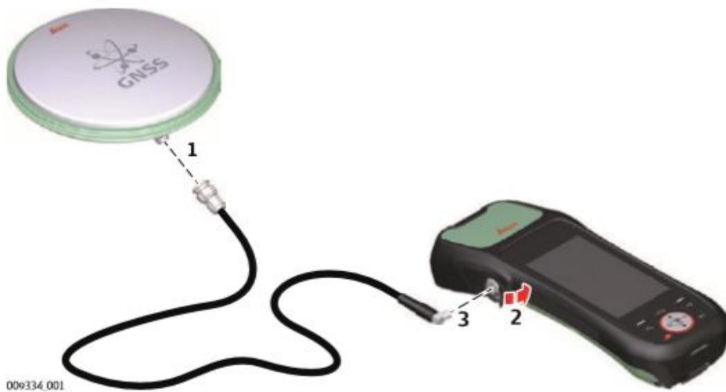
Рисунок 3.7 – Ілюстрація порядку підключення контролера та антени GNSS приймача Leica Zeno 20
