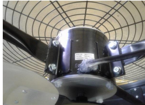
Рис. 2. Двигун електричний вентилятора
