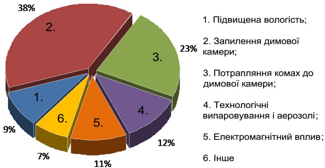
Рис. 3. Частка помилкових факторів пожежі, що призводять до спрацьовування димових оптико-електронних пожежних сповіщувачів
