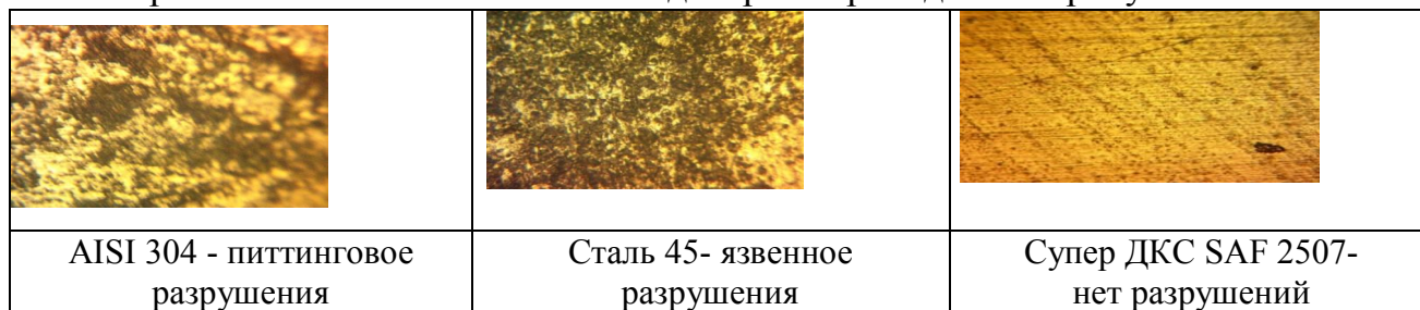
Рисунок 1 Микроскопическое исследование опытных образцов сталей после испытаний в пластовой воде нефтепромысла Ирака. Увеличение x 200.
