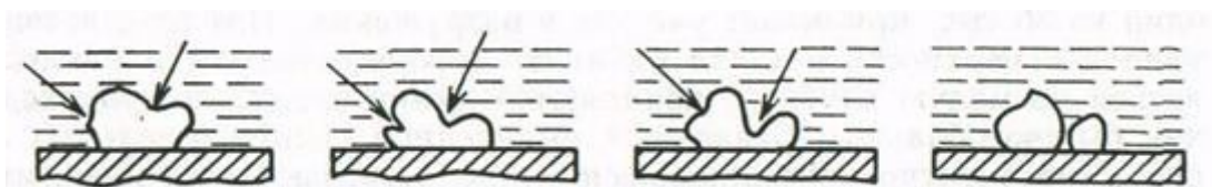
Рисунок 7.1 – Схема гідравлічних ударів при скороченні кавітаційних бульбашок
