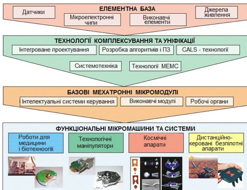
Рисунок 4.6 – Процес створення функціональних мехатронних мікромашин і систем
