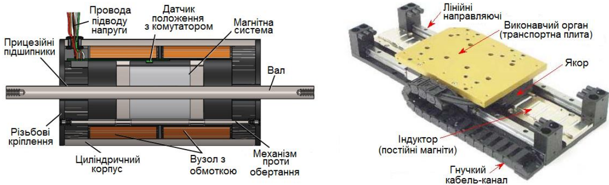
Рисунок 6.4 – Лінійний двигун і основні елементи
