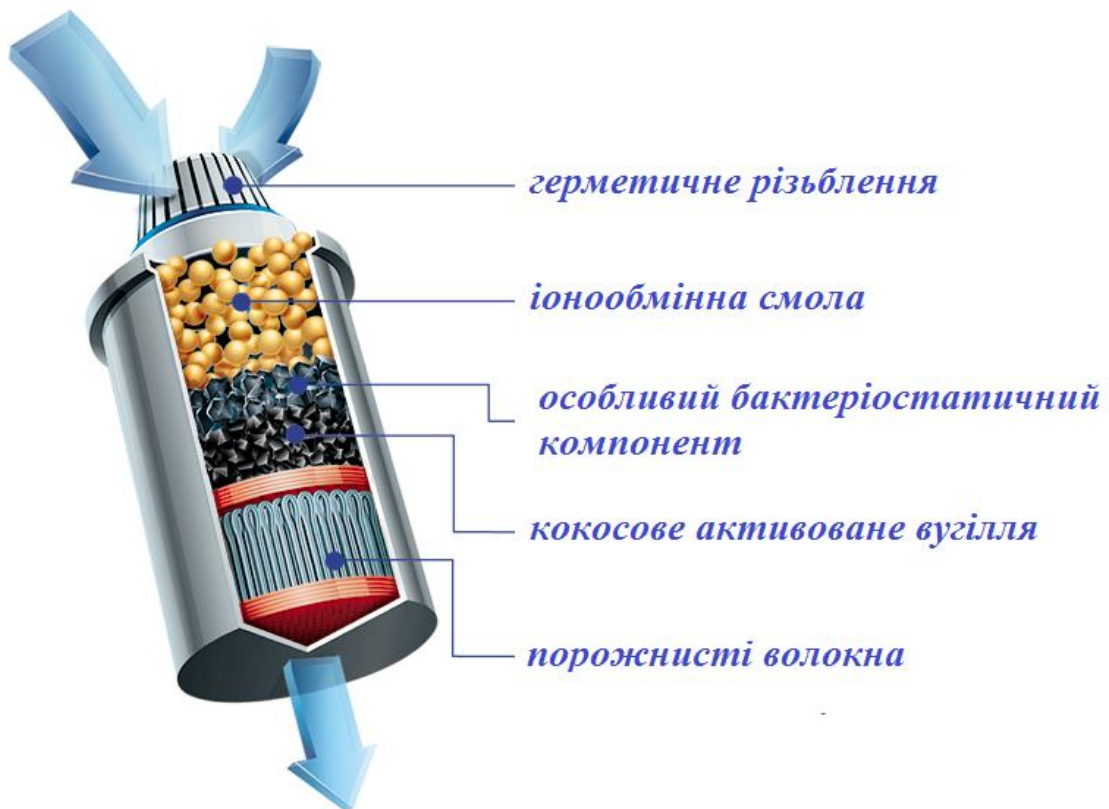
Рисунок 8.1 – Конструкція фільтрів типу глечика
