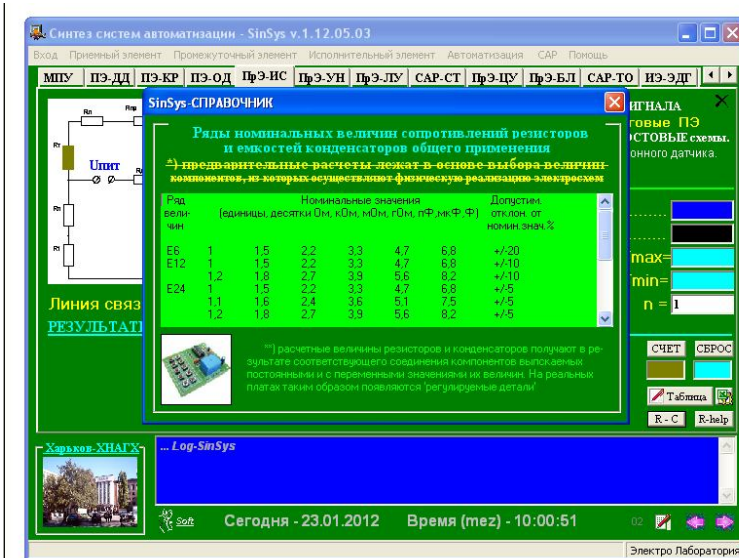
Рисунок 1.1 – Довідник ряду номінальних величин опорів резисторів в програмі SinSys (ПРЭ-ИС > R - C)
