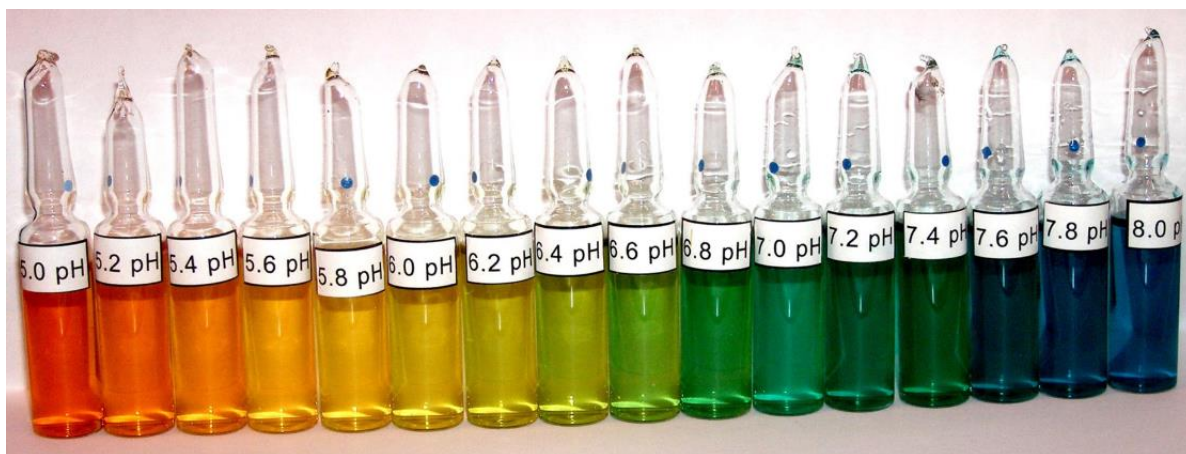
Рисунок 5.2 – Набір ампул для визначення рН з приладу Алямовського
