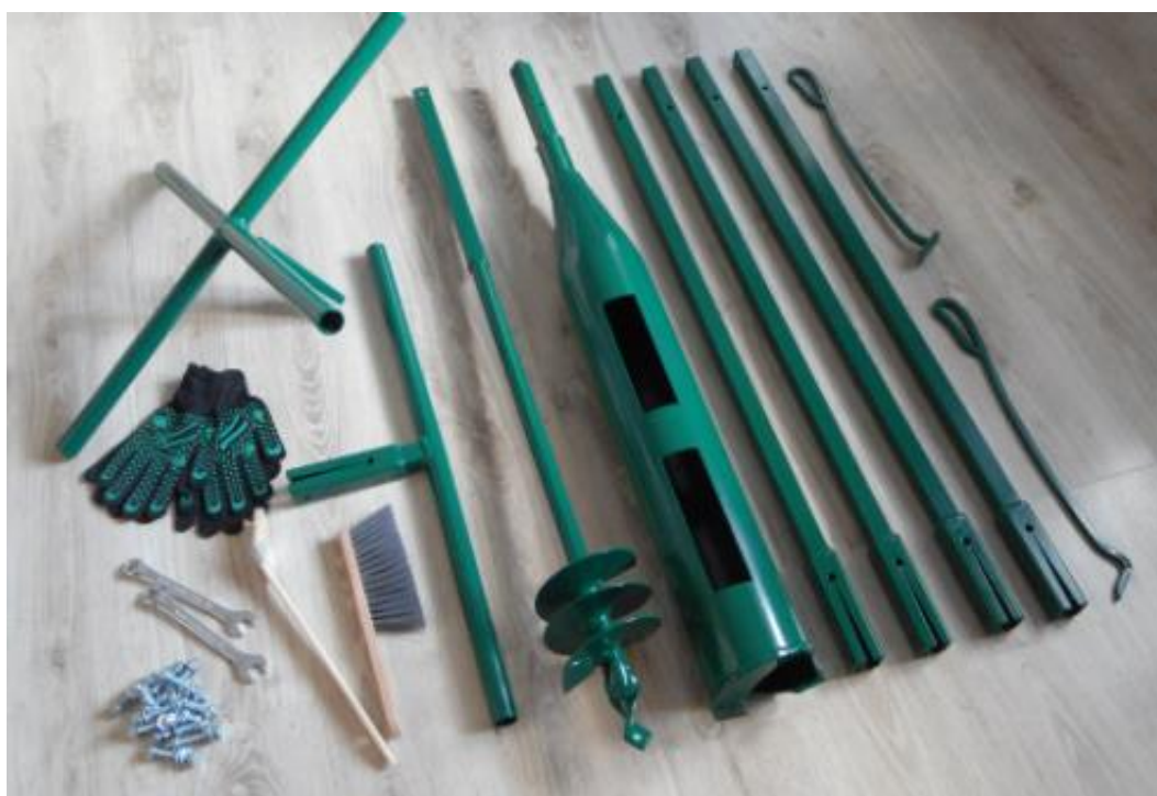
Рисунок 6.1 – Ґрунтовий бур БГ у розкладеному вигляді (робоча глибина до 5 метрів, діаметр збиральної гільзи 135 мм)
