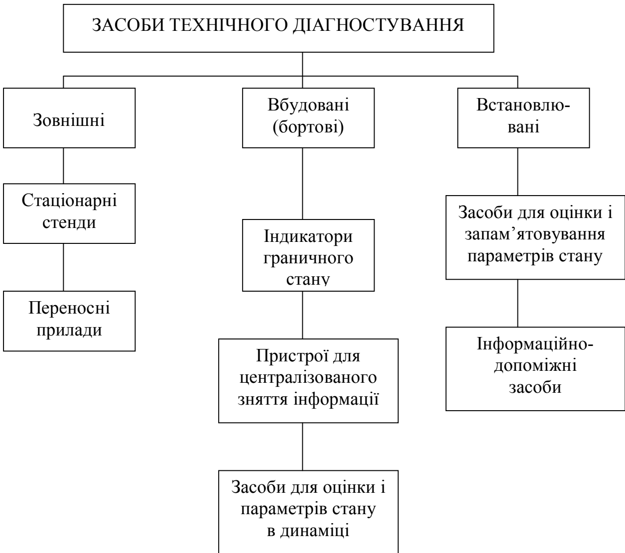
Рисунок 3.2 – Класифікація засобів технічного діагностування рухомого складу
