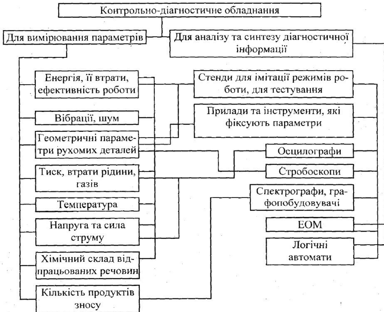
Рисунок 9.1 – Класифікація контрольно-діагностичного обладнання
