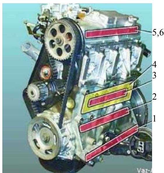
Рисунок 7.3 – Зони прослуховування стукотів в двигуні:
