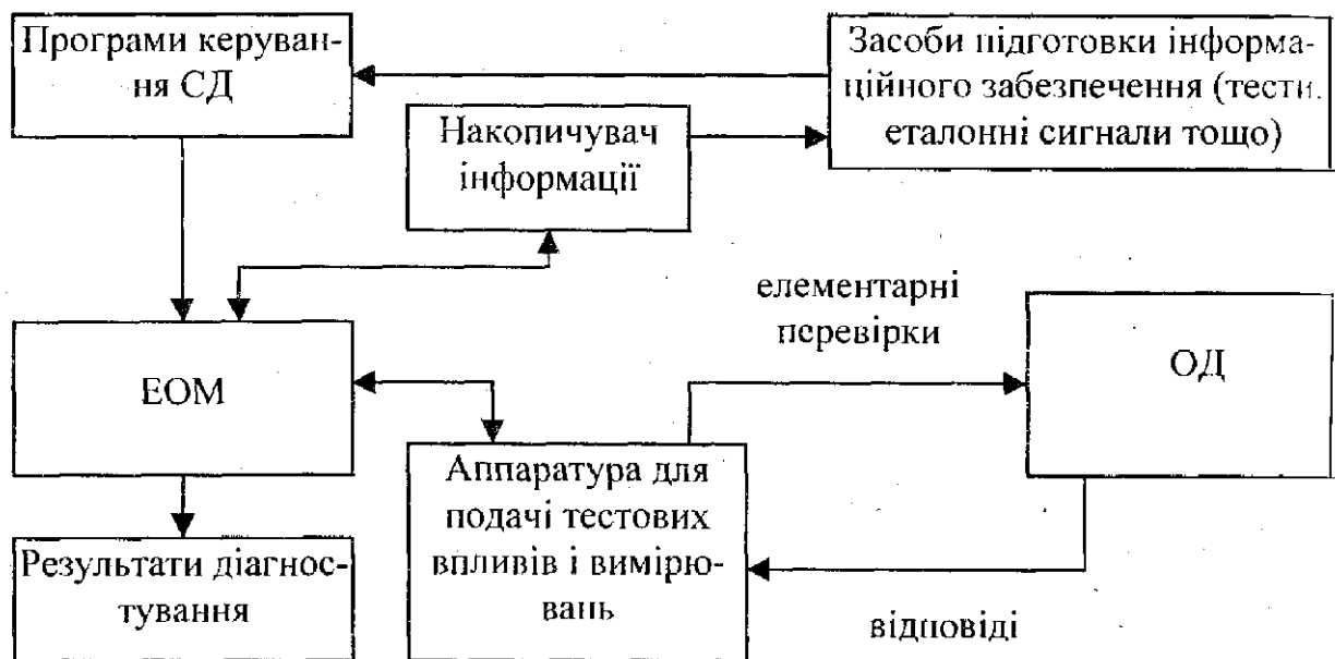
Рисунок 1.3 – Структурна схема комп'ютеризованих систем діагностування
