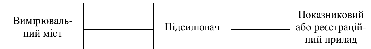
Рисунок 3.5 – Принципова схема вимірювального пристрою
