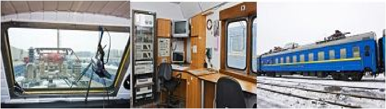
Рисунок 7.7 – Вагон-лабораторія контактної мережі
