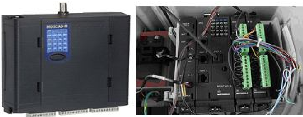
Рисунок 4.3 – Контролер MOSCAD і основні його елементи
