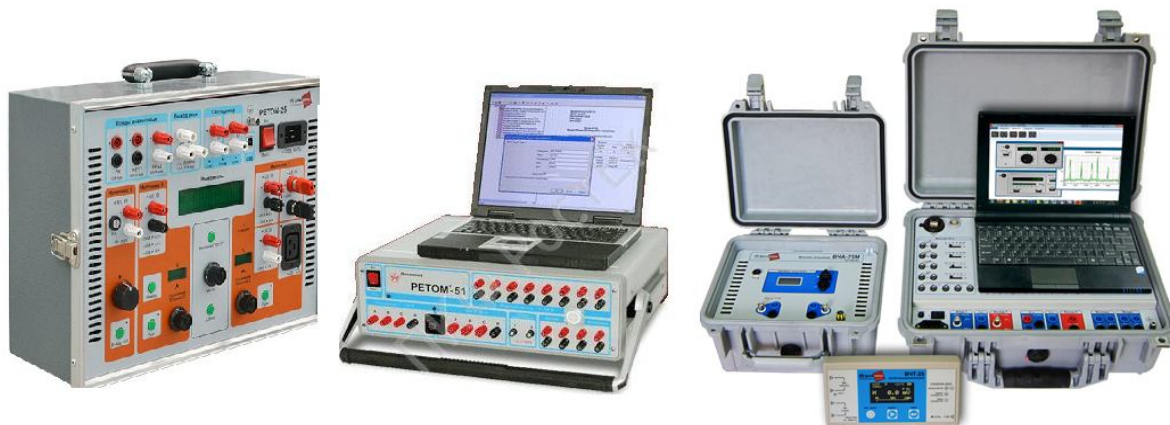
Рисунок 5.5 – Сучасні пристрої перевірки релейного захисту
