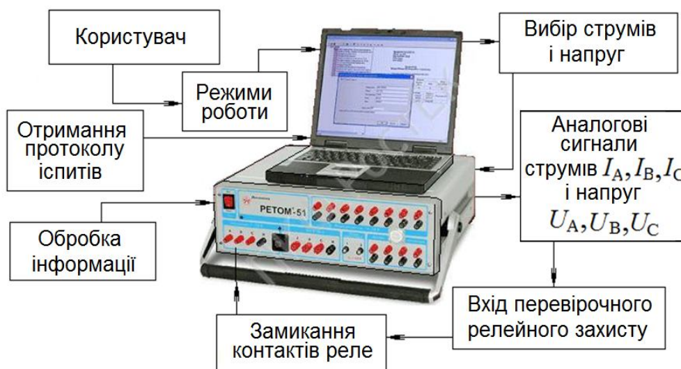
Рисунок 5.7 – Принцип дії автоматизованого комплексу перевірки релейного захисту
