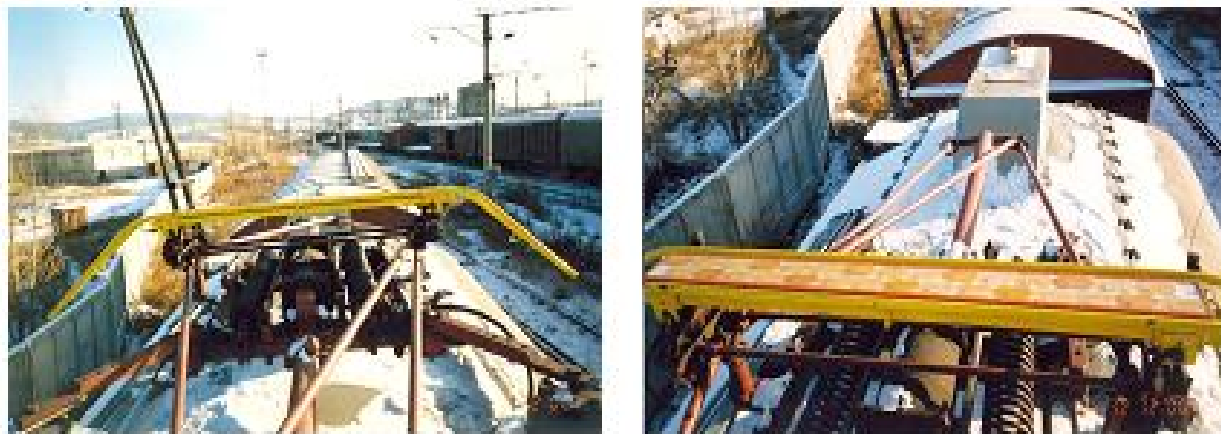
Рисунок 7.3 – Зовнішній вигляд вимірювального пантографа в робочому положенні на даху пересувної лабораторії
