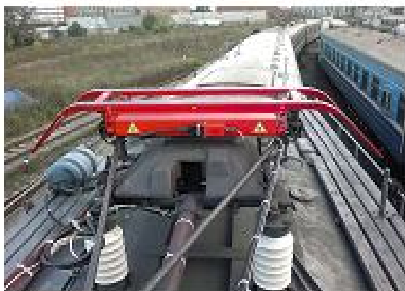
Рисунок 7.5 – Система безконтактного вимірювання профілю зношеної частини контактної провладу та відображення 3D-моделі
