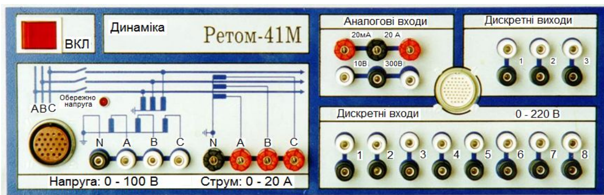
Рисунок 5.8 – Лицьова панель комплексного пристрою РЕТОМ
