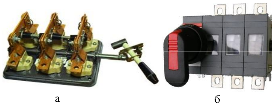
Рисунок 4.10 – Роз'єднувач із залежними операціями замикання та розмикання (а) та вимикач-роз'єднувач з незалежними операціями замикання та розмикання (б).
