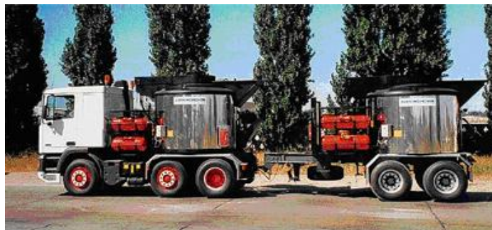
Рисунок 30 – Котли для транспортування литого асфальтобетону
