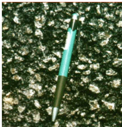
Рисунок 44 – Структура поверхні покриття ЩМА-20
