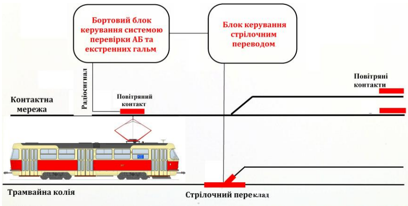
Рисунок 1 – Схема автоматизованої системи для визначення можливості руху трамвайного вагону на ухил
