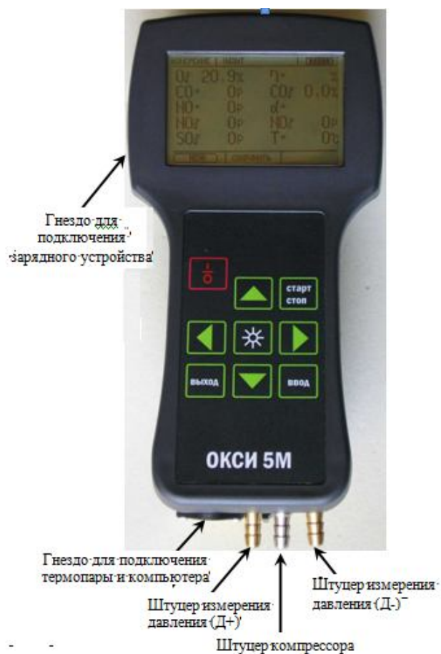
Рисунок 4.1 – Внешний вид газоанализатора ОКСИ 5М
