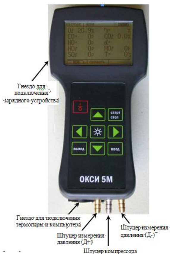
Рисунок 3.1 – Внешний вид газоанализатора ОКСИ 5М
