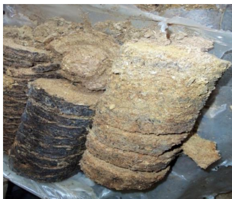
Рис. 4. Паливні брикети виготовлені по технології NESTRO після транспортування у вологу погоду в негерметичній упаковці, помітна цвіль.
