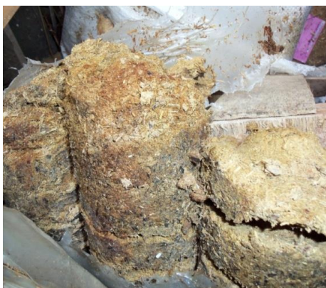
Рис. 3. Паливні брикети виготовлені по технології NESTRO після зберігання без упаковки.
