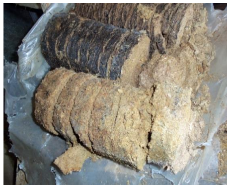
Рис. 5. Паливні брикети виготовлені по технології NESTRO після зберігання при значних коливаннях температури, помітна цвіль.
