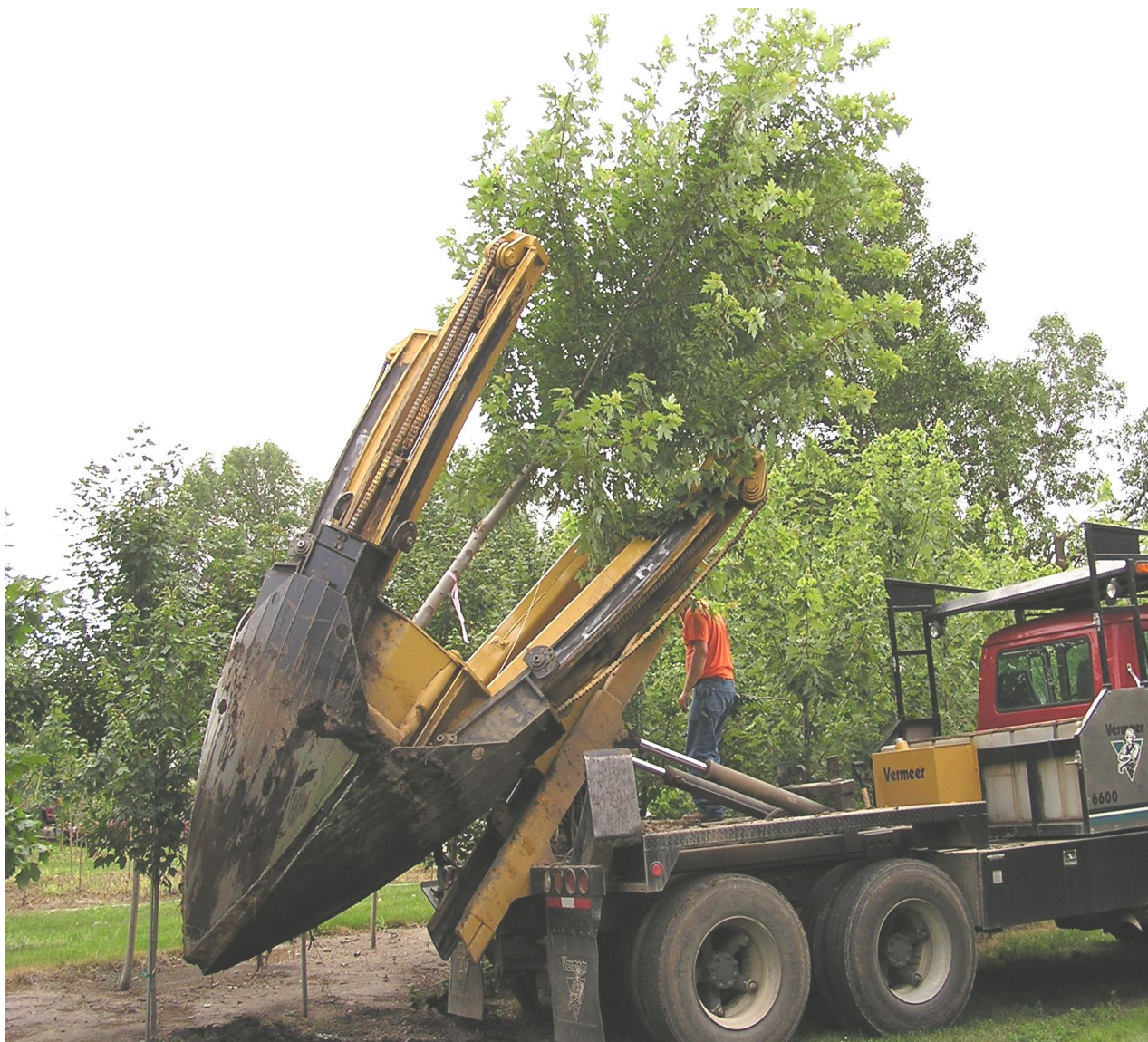
Рисунок 2.4 – Збереження зелених насаджень на території об’єкта будівництва шляхом пересаджування
