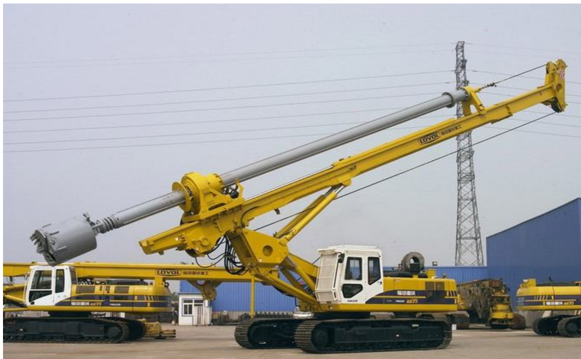
Рисунок 5.12 – Установка для роторного буріння
