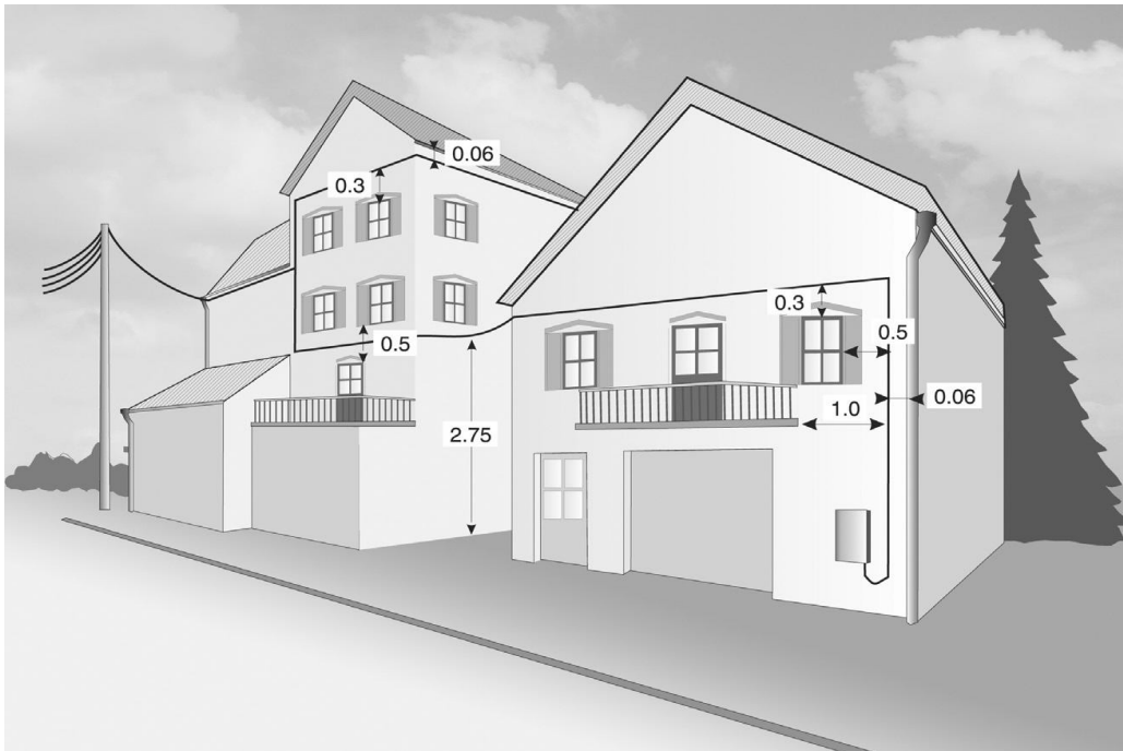
Рисунок 11.1 – Відстані для прокладки СІП стінами будівель
