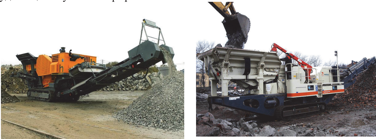
Рис. 3. Переробка відходів бетону на вторинний щебінь за допомогою мобільного дробильно-сортувального комплексу
