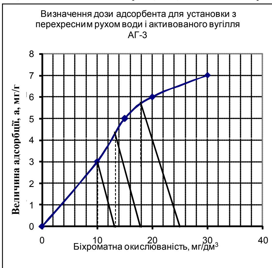
Рисунок 2.8 – Визначення дози адсорбенту для триступеневої установки з перехресним рухом води і активованого вугілля АГ-3
