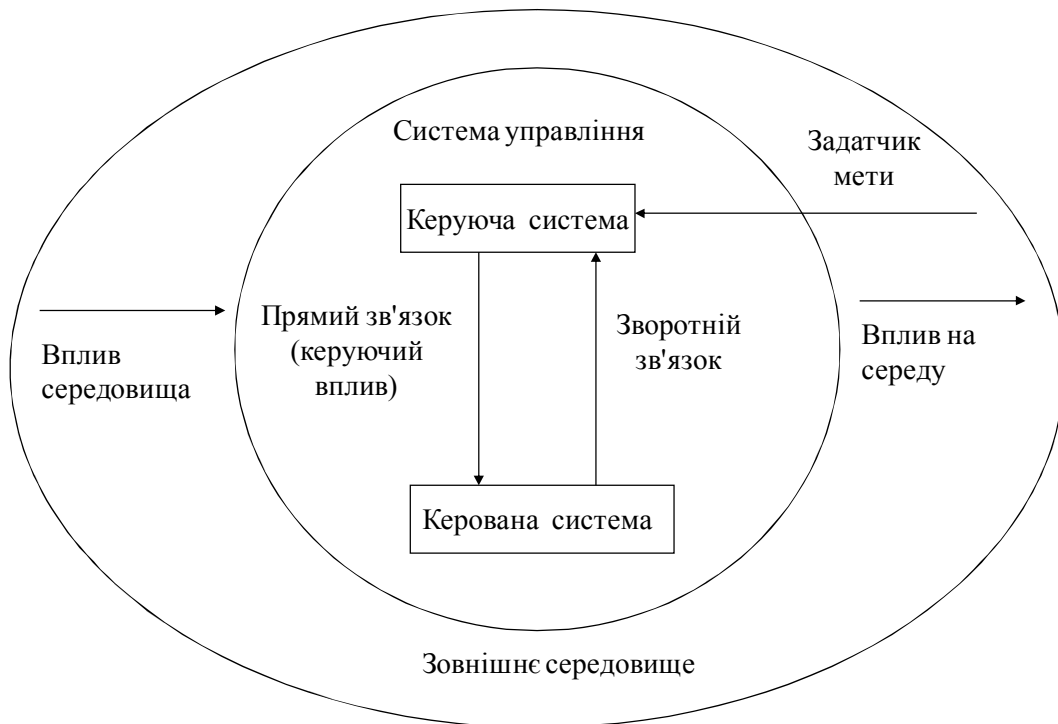
Рисунок 1.4 – Найпростіший контур управління системою
