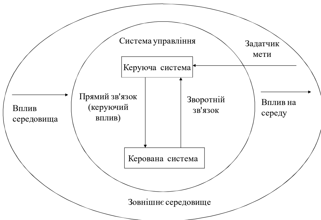
Рисунок 2.2 – Найпростіший контур управління системою
