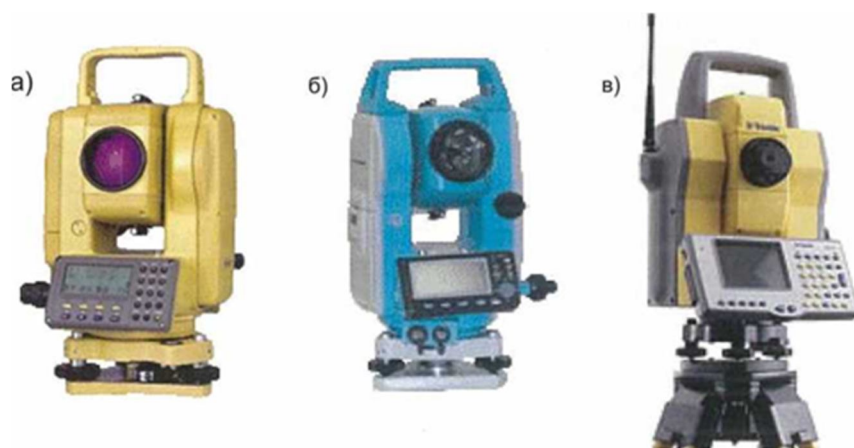
Рисунок 3.52 — Тахеометри: а – електронний тахеометр South NTS-352; б – електронний тахеометр Sokkia SET 510 R; в – автоматизований тахеометр Trimble 5600 DR
