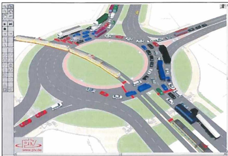
Рисунок 9.4 – Тривимірна візуалізація транспортних потоків у системі PTV Vision за допомогою модуля VISSIM
