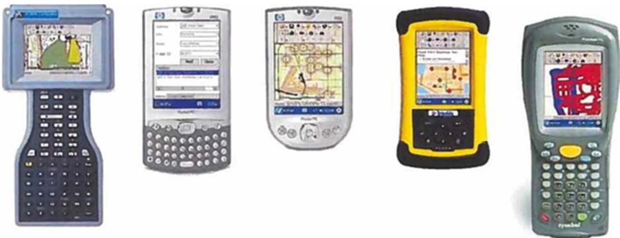
Рисунок 8.7 – Різноманітні портативні пристрої, із мобільного ГІС ArcPad і побудованих на базі технологій (зліва направо) handheld, WindowsPC, Pocket PC, Windows Mobile, Tablet PC
