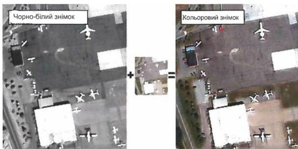
Рисунок 8.4 – Поєднання чорно-білого знімка з високою роздільною здатністю (зліва) із менш чітким, але кольоровим знімком (в центрі) для отримання кольорового знімка з високою роздільною здатністю (праворуч) за допомогою алгоритму pan-sharpening
