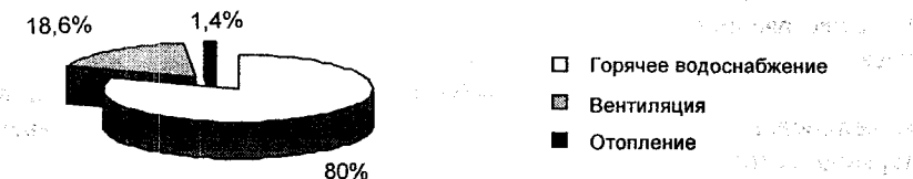
Рис.2 – Структура потребления тепловой энергии инженерными системами здания
