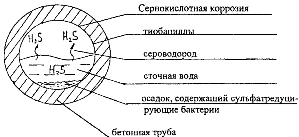
Рис.1 – Схема коррозии бетонных труб
