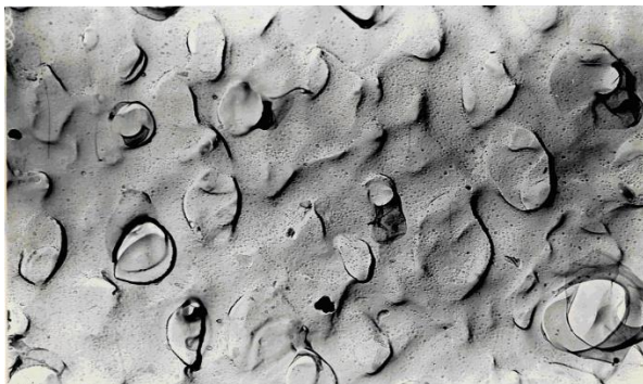
Рис. 4. Мікроструктура гідроксилапатиту \text{Ca}_{10}(\text{PO}_4)_6(\text{OH})_2 , після випалу при 1200\text{ }^\circ\text{C} , \times 17000
