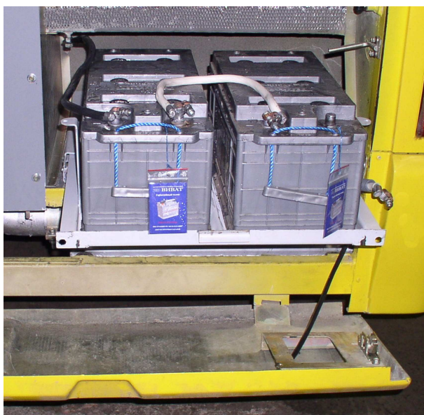
Рис. 1.1 – Розташування акумуляторних батарей
