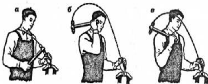
Рисунок 5.7 – Удари молотком: а – кистьовий; б – ліктювий; в – плечовий
