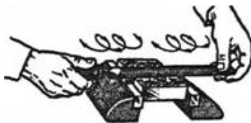
Рисунок 5.9 – Припилювання поверхні з перевіркою «на фарбу»
