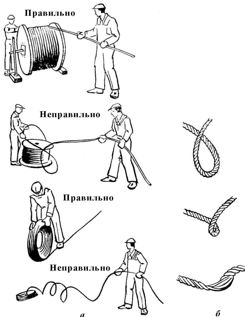
Рисунок 1.2 – Розмотування і розгинання канатів: а – прийоми розмотування канату з котушки або бухти; б – заломы, які неприпустимі при розмотуванні
