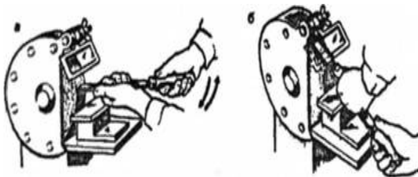
Рисунок 6.3 – Заточування плоского шабера: а – краю; б – бокової поверхні
