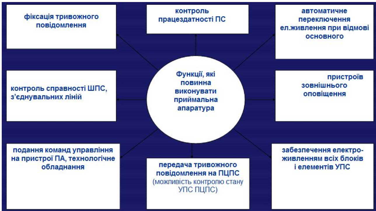
Рисунок 8.1 – Функції, що виконуються приймальною апаратурою УПС
