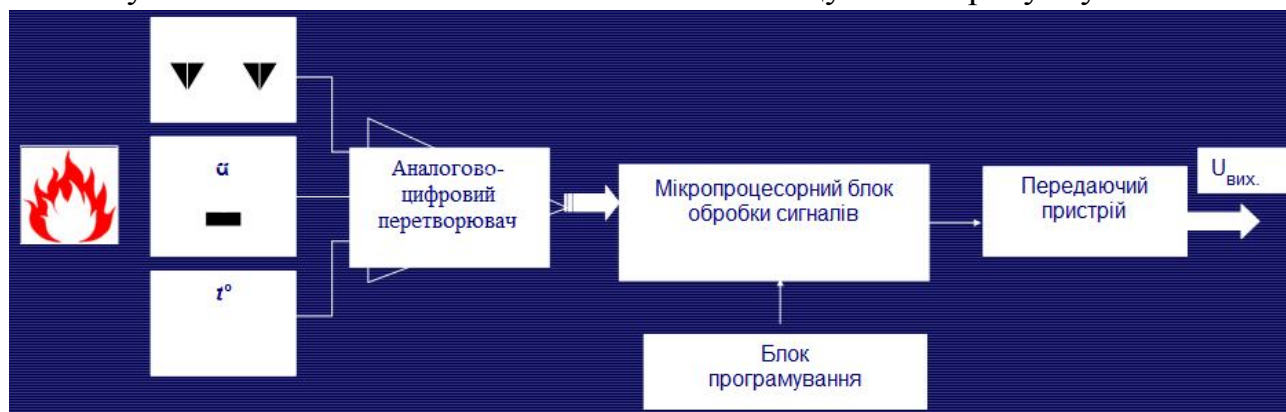
Рисунок 7.5 – Схема комбінованого пожежного сповіщувача
