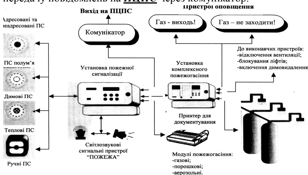
Рис. 8.7 – Комплекс технічних засобів для АУПГ «Фотон-ПТ»
