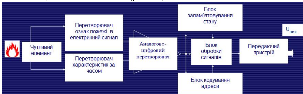
Рисунок 7.4 – Загальна схема аналогово-цифрового адресованого пожежного сповіщувача
