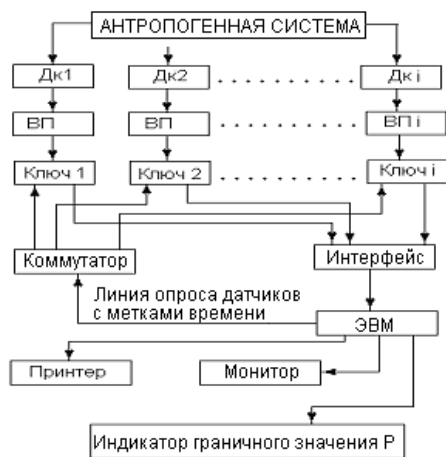
Рисунок 2 - Функциональная схема контрольно-измерительной системы технической диагностики
