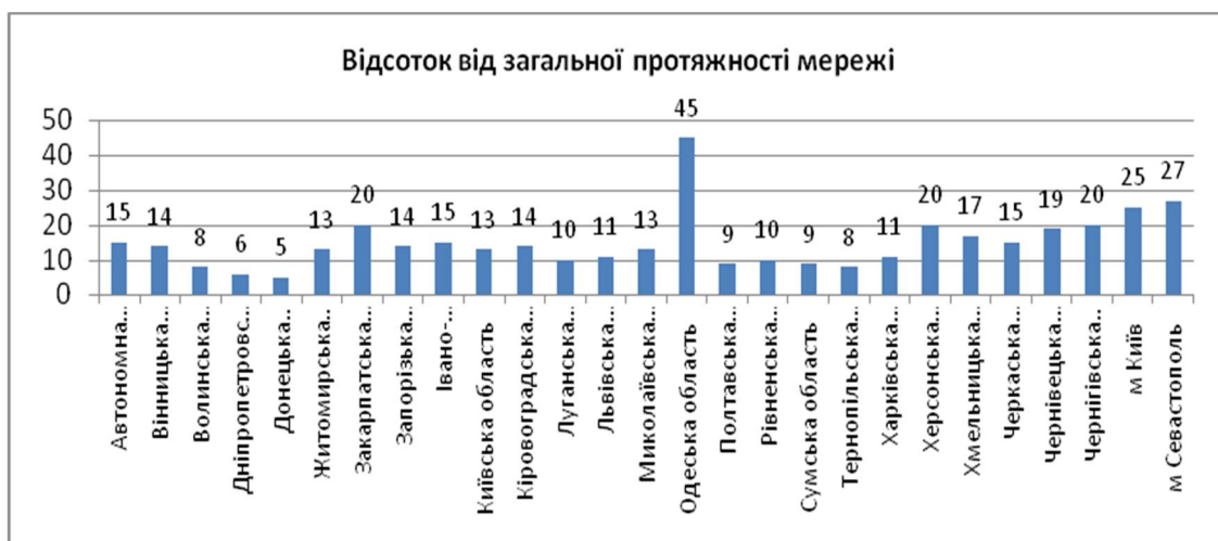
Рисунок 1.4 – Частка старих і аварійних теплових мереж
