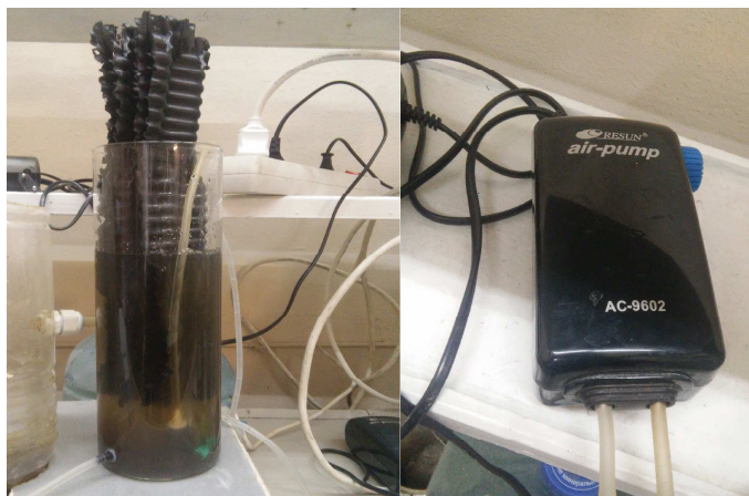
Рисунок 1 – Установка для іммобілізації мікроорганізмів з активного мулу на носій.
