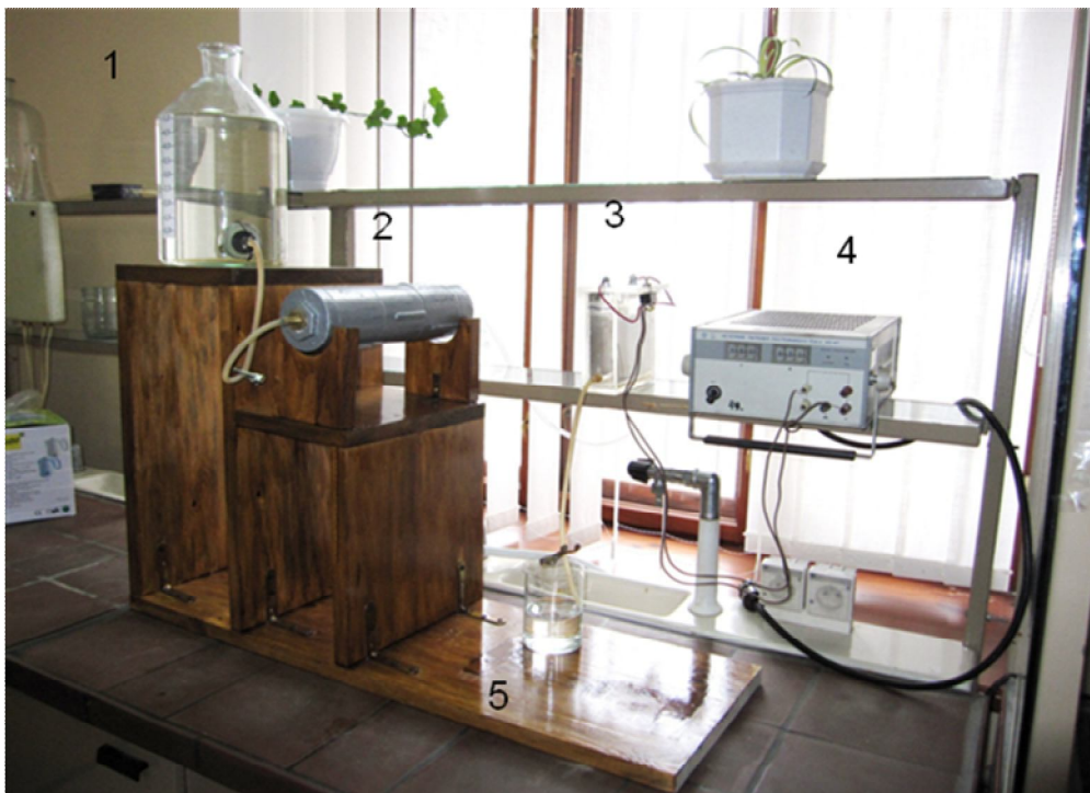
Рисунок 7.3 – Лабораторна установка для активації розчину коагулянту
