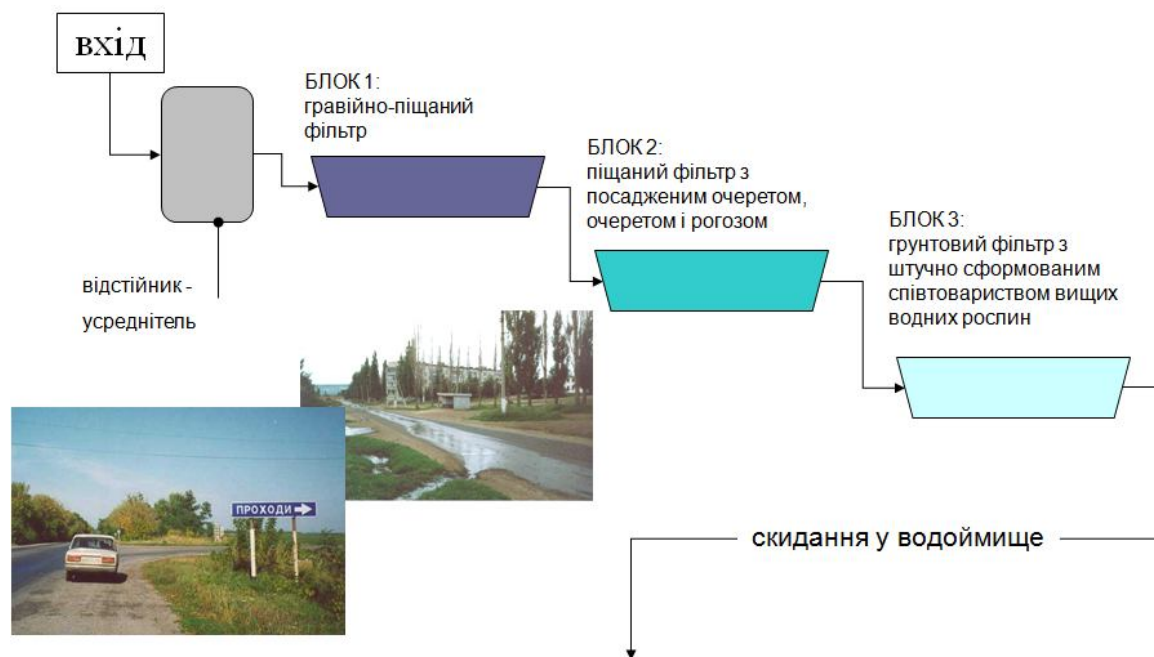
Рисунок 11.1 – Схема комплексу очищення стічних вод «Біоплато»
